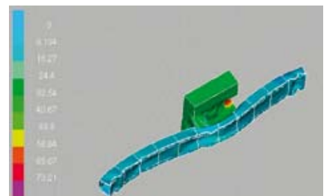
Bild 2: Farbliche Hervorhebung der Unterschiede zwischen interpolierten und simulierten Ergebnissen. Im Beispiel (B-Säule eines Fahrzeugmodells der Audi AG) ist der Unterschied gering.
