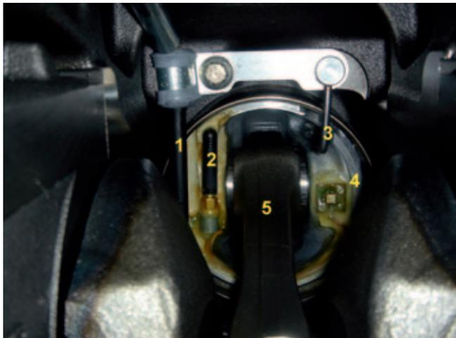
Unterseite des applizierten und eingebauten Kolbens. 1: Sendeantenne mit Kabel aus dem Kurbelgehäuse; 2: Empfangsantenne; 3: Kolbenkühlöse; 4: SAW-Sensor; 5: Pleuel.
