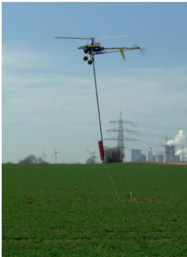
Die flächenhafte Messung eines Messgebietes mit der neuen Messplattform an UAVs wird die Anzahl der Bohrungen reduzieren und Informationen liefern, mit denen Bohrungen gezielt eingesetzt werden können. Damit reduzieren sich auch die kostenintensiven Standortuntersuchungen.
