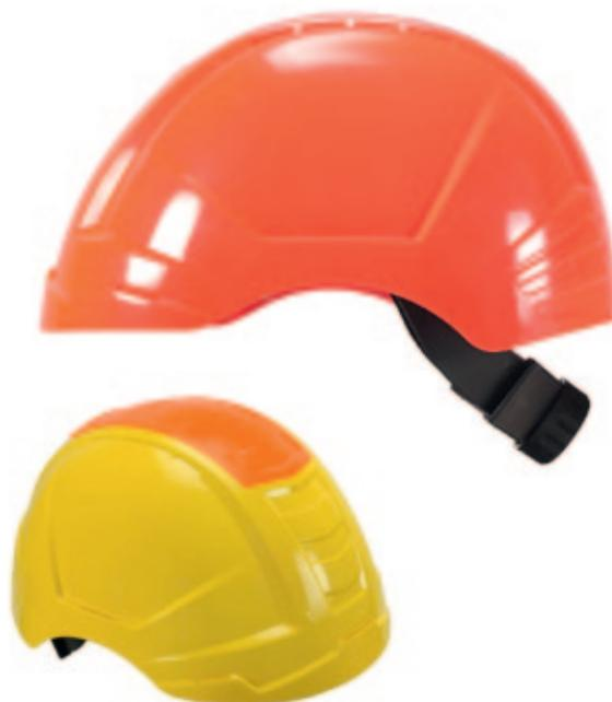
Die CRASHBOX ermöglicht, die Beaufschlagungsenergie – etwa eines fallenden Gegenstandes – bereits durch die Helmschale und nicht erst durch seine Innenausstattung zu absorbieren. Die CRASHBOX entspricht in ihrer Wirkungsweise der Knautschzone moderner Kraftfahrzeuge. Die CRASHBOX enthält zahlreiche kleine Zylinder und Röhren, die sich bei Beaufschlagung ineinander verdrehen.
