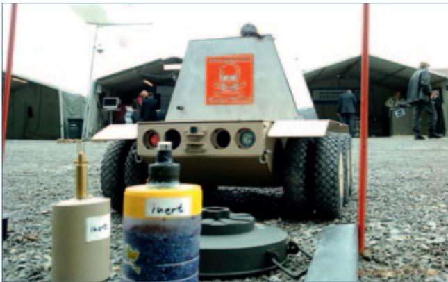
Bodengestützter Nachweis von Sprengstoffspuren mittels scannenden Lasers, montiert auf Landroboter (Un-manned Ground Vehicle UGV). Teilnahme European Land-Robot Trial M-ELROB 2010
