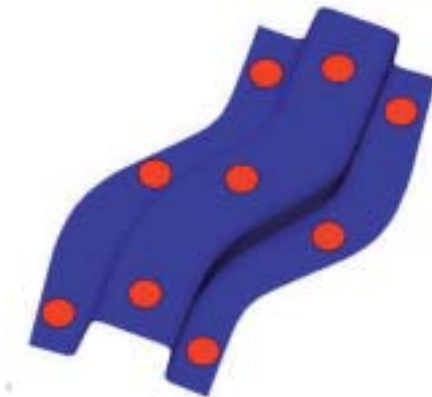
Abb. 2: Kreise am Testfall Srail zur Bestimmung des Abstands von der gewünschten Form
