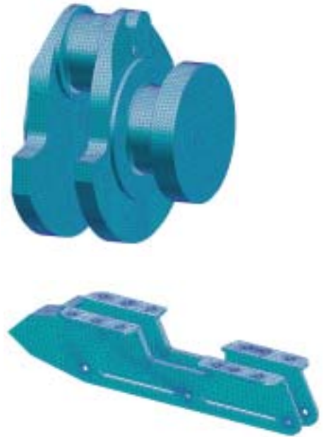
Gittermodelle einer Kurbelwelle (ca. 950.000 Unbekannte) und eines Inliners (ca. 500.000 Unbekannte) (Audi, McNeal Schwendler)
