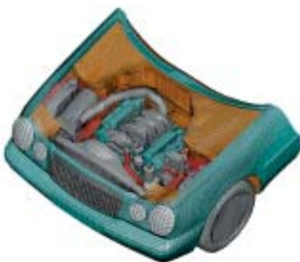
Gittermodell für die Strömungssimulation im Motorraum (Computational Dynamics Ltd.)
