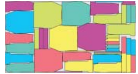
Schnittbild für Röhre. Die unterschiedlichen Farben markieren die verschiedenen Teile.
