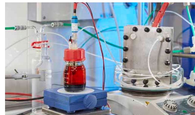
Laboraufbau einer organischen Redox-Flow-Batterie
